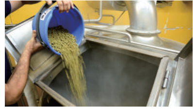
厳選したホップを麦汁の入った煮沸釜へ。その後、冷却して発酵タンクで熟成させる。
