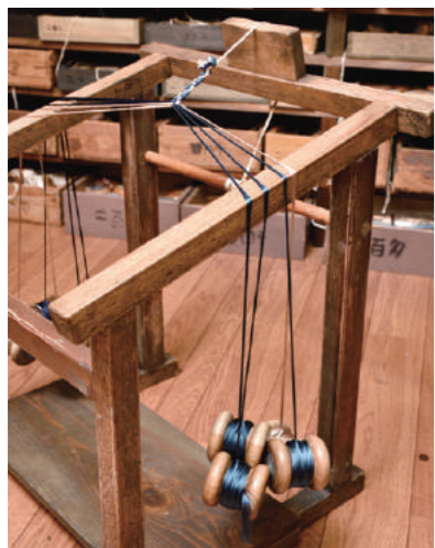
組紐を組む際に使う糸をまとめた「玉」は、重打では9個と少ない。組み目がわかりやすくなるため、ごまかしが効かない。
