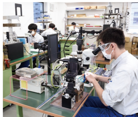
極めて細い熱電対の製造過程において、素線の溶接などは、顕微鏡を覗きながら手作業で行う。類いまれな集中力と繊細な技術を要する。
